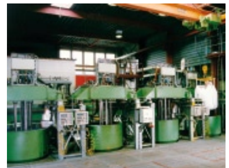
Abb. 2: Eine Anlage der NateCO 2 GmbH & Co. KG zur Hochdruckextraktion mit überkritischem CO 2 .
